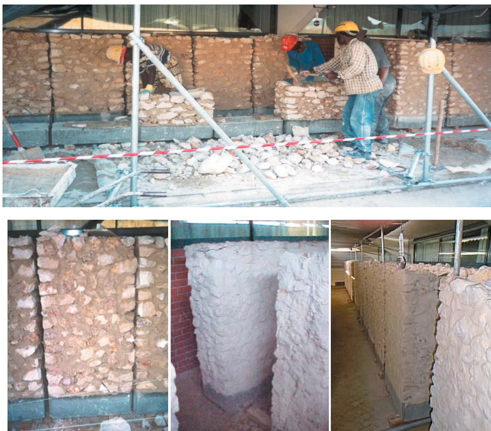
Fig. 1 – Execução e ambiente de cura dos modelos experimentais (muretes) de alvenaria de pedra tradicional
